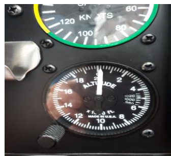
Altimètre secours calé à 180 ft
