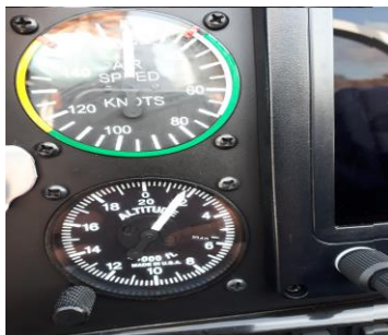
Altimètre secours calé à 1800 ft
