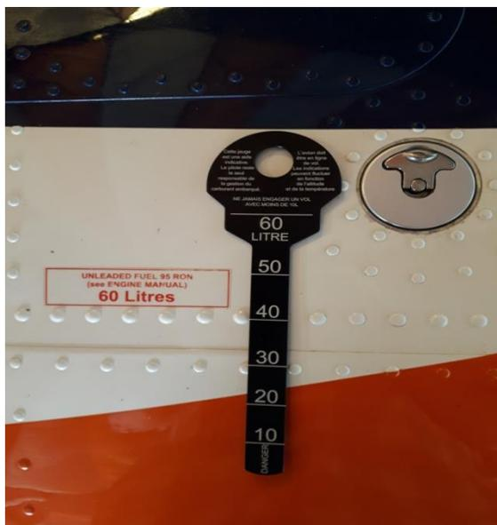
Rappel : de manière générale il est recommandé de ne pas dépasser 40 l de carburant dans chacun des réservoirs, ce qui permet à un équipage de 2 PAX de gabarit standard (<2x80kg) d'utiliser l'avion sans vérifier le devis masse/centrage. Pour les voyages, vols solos, etc. l'avitaillement pourra dépasser cette recommandation. Il conviendra en préalable de chaque vol de faire un devis de masse/centrage.
