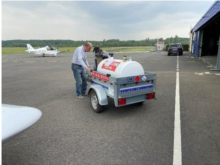
**4- Mettre en place le câble équipotentiel entre la cuve et l'aéronef**
